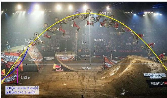
Abb.1: Ausmessung der Flugbahn
