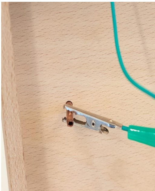
Figuur 11: krokodillenklem kan onderaan bevestigd worden aan de doorgestoken koperbuis.
